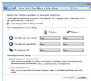
睡眠与挂起到 RAM (STR) 相同。此功能在许多组件关闭的情况下在 RAM 中存储当前数据和状态。由于 RAM 是易失性的，因此，它需要电量来保持（刷新）数据。单击开始按钮和锁图标旁边的箭头可以看到此选项。您也可以使用快捷键 [Fn F1] 来激活此模式。按一下键盘上除 [Fn] 以外的任意键可恢复。（备注：在此模式下电源指示灯将闪烁。）
