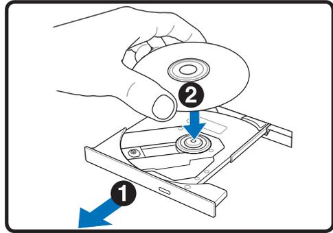
2. 轻轻拉光驱的前面板，将托盘完全拉出。注意不要碰到光驱的激光头和其它机件。确保没有任何障碍物卡住光驱托盘。
