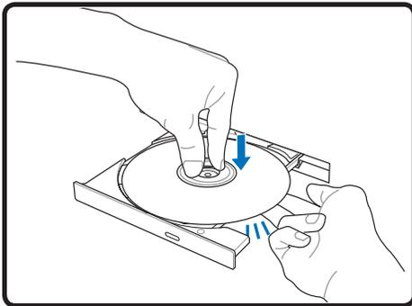
3. 拿住光盘的边缘，使带标签的一面朝上。向下按光盘中心的两边，直到其扣入轮轴。装入正确时轮轴应高于光盘。
