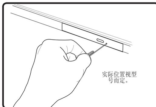
光驱上有一个紧急弹出孔，用于在电子弹出不起作用时弹出光驱托盘。请勿在能够使用电子弹出的情况下使用紧急弹出。备注：一定不要触碰同一区域内的活动指示灯。
