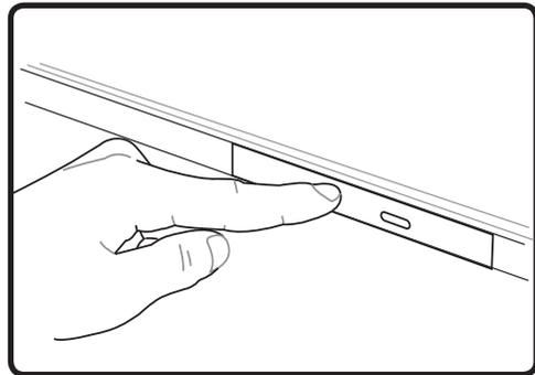
4. 轻轻向里推回光驱托盘。光驱将开始读取光盘上的目录 (TOC)。光驱停止时，光盘即可使用了。
