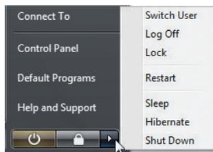
休眠等同于挂起到磁盘 (STD)，它将当前数据和状态存储在硬盘上。这样，RAM 不必定期刷新，能耗也大幅度降低，但并非完全不耗电，因为特定唤醒组件（如 LAN）需要保持供电。与“Sleep”（睡眠）相比，“Hibernate”（休眠）可节省更多电量。单击开始按钮和锁图标旁边的箭头可以看到此选项。按下电源按钮可恢复。（备注：在此模式下电源指示灯将熄灭。）
